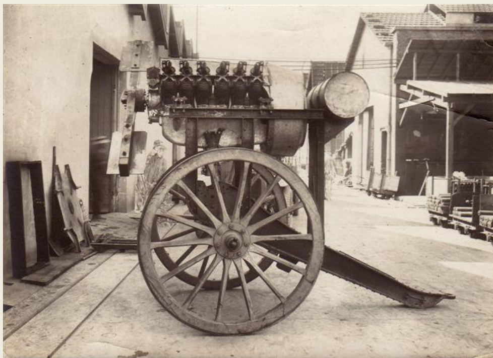
Moteur au banc d'essais sur un affût de canon. (Collection René Lemaire).
