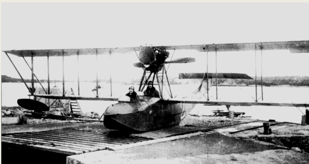
Hydravion Donnet-Denhaut type DD-8 à moteur Lorraine V8 de 170 ch. Deux cents de ces hydravions de combat furent commandés par la Marine en 1916. (Musée de Biscarrosse).
