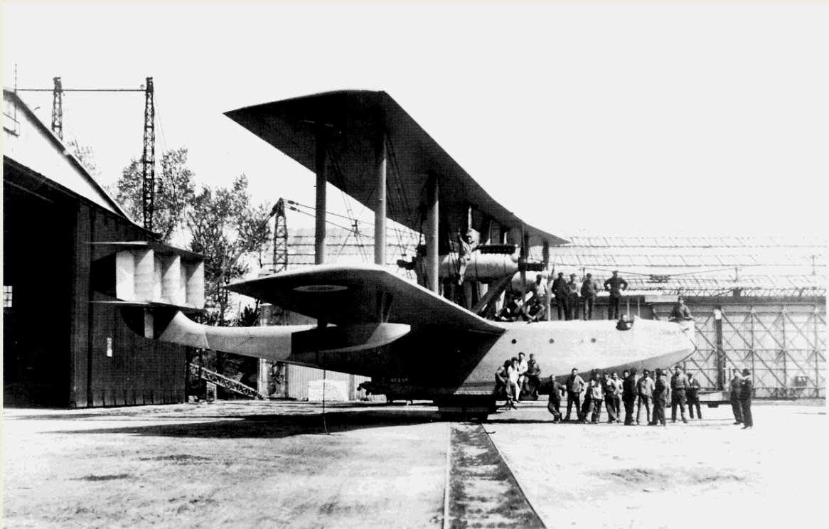
Autre hydravion géant, le quadrimoteur Latham du programme d'exploration lointaine en haute mer pour cinq hommes d'équipage de l'aviation maritime, sorti en 1925, était propulsé par quatre moteurs Lorraine 12 Db de 400 ch. Il devait patrouiller sept à douze heures. (Cliché Musée de l'Air).
